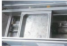
測試條件：將樣品正確安裝在耐久性測試機上，將24.5KG裝載在抽屜內，進行持續性推拉運動，速度12次循環/分鐘，觀察樣品的變化，並記錄商品達到相應次數時的狀態。
