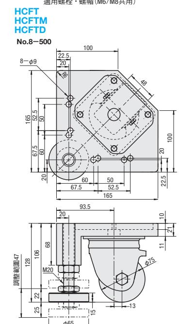
◎以腳輪移動時，請將調整腳墊完全拉起。
