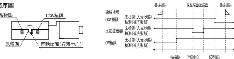
CW方向 ← 機械極限 原點端面 行程中心 反端面 CCW方向
