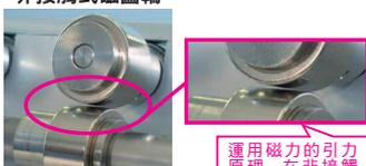
運用磁力的引力原理，在非接觸狀態下傳導磁力。
