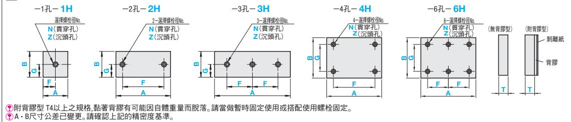
♀ 附背膠型 T4以上之規格,黏著背膠有可能因自體重量而脫落。請當做暫時固定使用或搭配使用螺栓固定。
