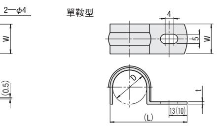
◎ 因為使用薄鋼金製造，(L)尺寸、(P)尺寸為參考尺寸。
