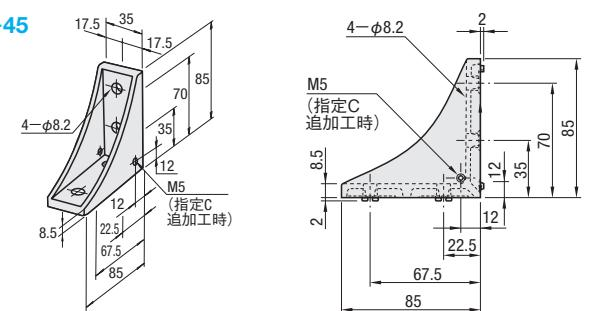
■特長：鋁製的擠型角撐架。美觀且不堆積灰塵的設計。
