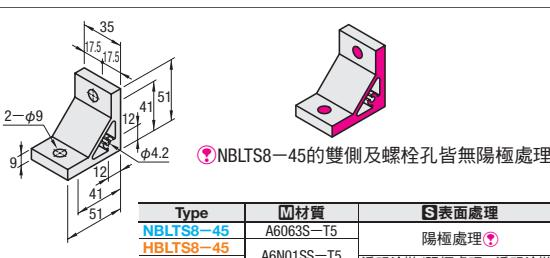
■特長：1面有2個安裝孔的擠型角撐架。可更牢固地連接擠型架。
