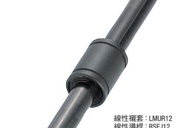
線性襯套的鍍低溫黑色鉻，是將氟化合物(膜厚約5μm)以化學方法貼覆於黑色薄膜上，具有長期防鏽的效果。
